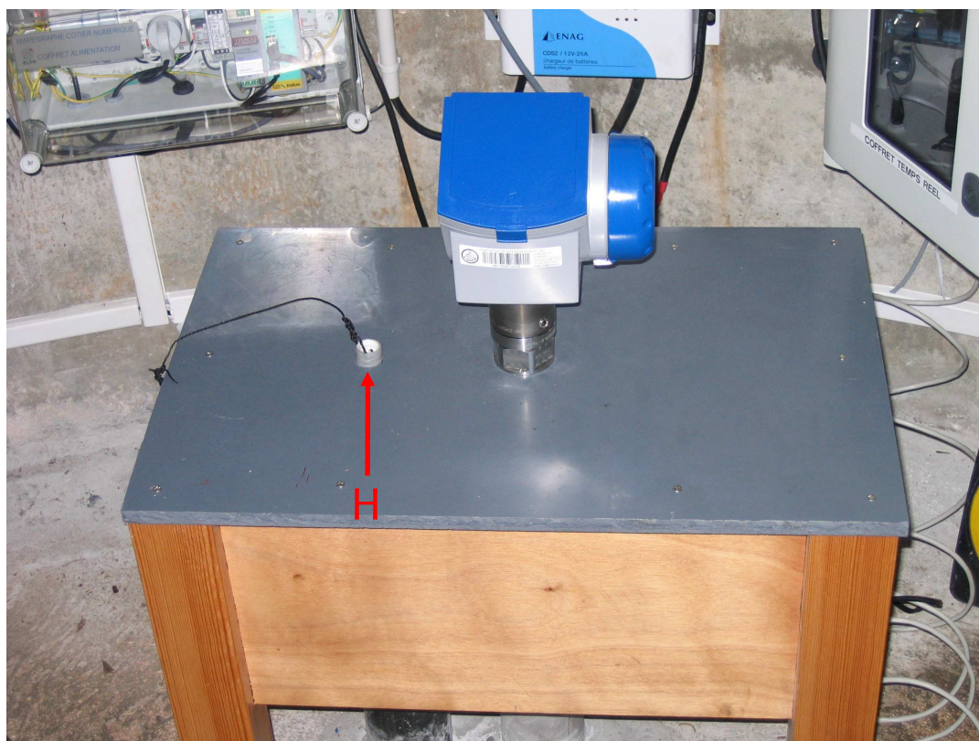
Fig.8 : Vue de l'index pour les mesures de contrôle à la sonde lumineuse (repère H)
